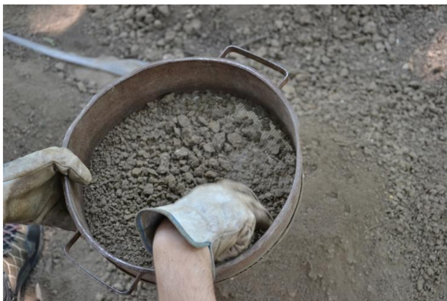
Figura 3 - La setacciatura a secco (maglie di 2 mm) del sedimento
